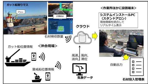
図-8 デジタルツインシステム概念図
