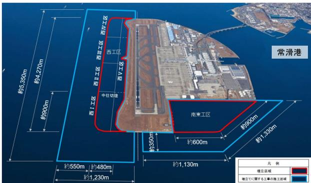
図-1 名古屋港新土砂処分場整備事業計画平面図
