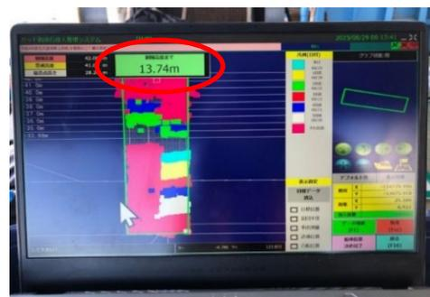
写真-4 システム画面（ブーム先端高さ表示）
