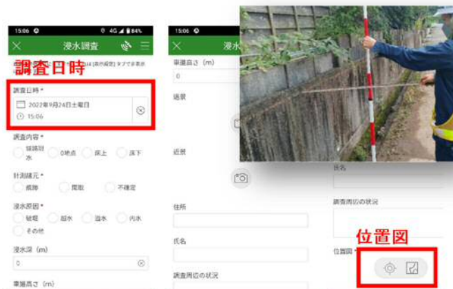
図-3 浸水痕跡調査(アプリと調査写真)
