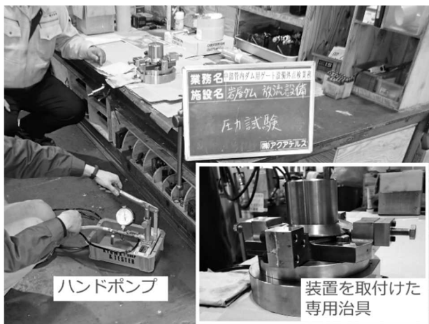
写真-6 耐圧試験の様子
