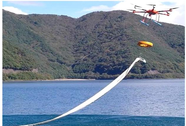
写真-2 大型ドローンによる運搬状況
