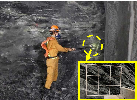
写真-1 5cm四方の網による割れ目間隔の把握
