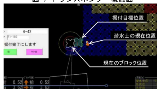
図-9 クレーン操縦者のモニター画面
