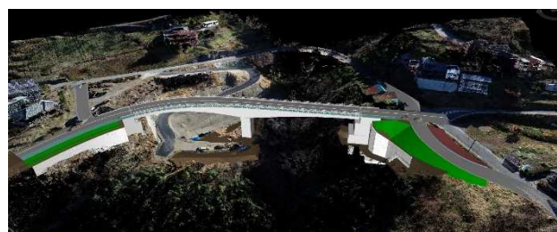
図-3 2次元図面を基に作成した3次元モデル
