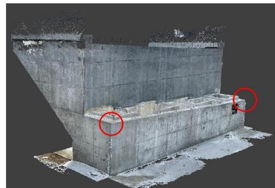
図-11 点群データの合成方法(特徴点)
