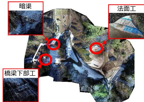
図-7 携帯端末 LiDAR 取得箇所位置図
