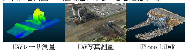
図-2 測量の試行例（河原田排水樋管）
