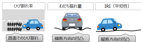
図-5 舗装点検項目
