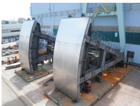
図-5 高圧ラジアルゲート（参考：鹿野川ダム） 2)
