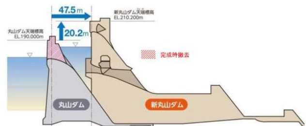
図-1 新丸山ダム断面図
