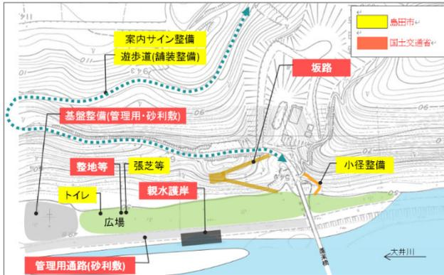
図 5 蓬莱橋右岸側整備概要図
