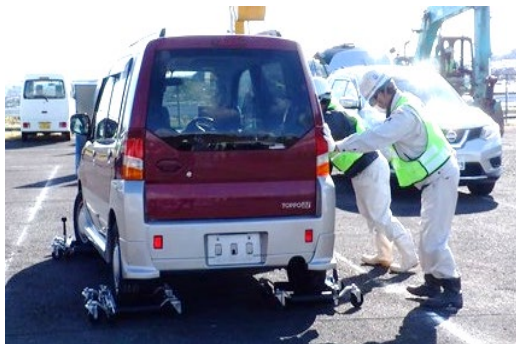
図-9 ゴージャッキによる放置車両の移動
