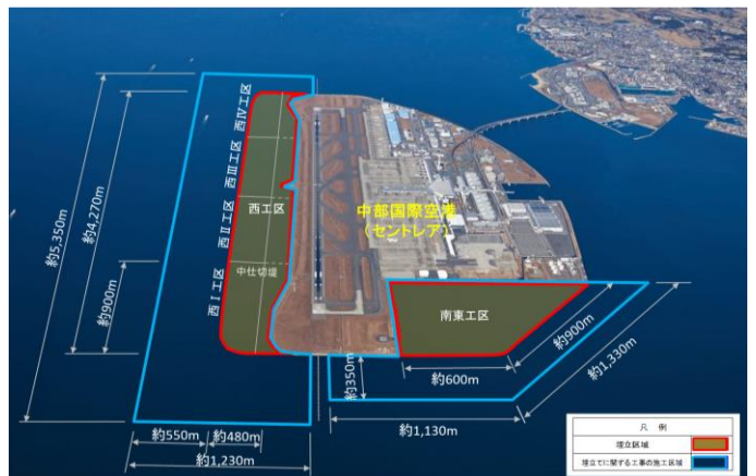
図-1 新土砂処分場埋立護岸の配置
