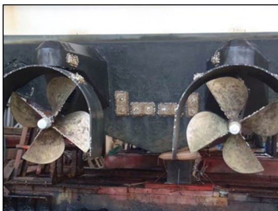
写真－1 レビドライブユニット搭載状況
