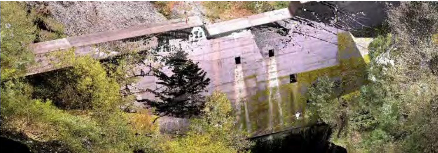
地上レーザ計測点群構造物モデル
