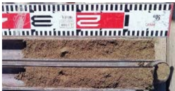
写真-5 ボーリング調査による採取試料（購入砂）
