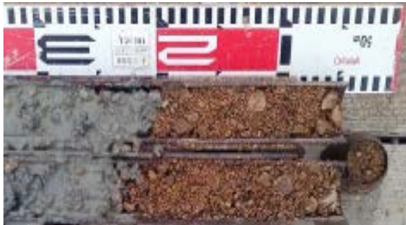
写真-6 ボーリング調査による採取試料（流用砂）
