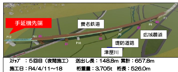
図-15 送出しステップ図
