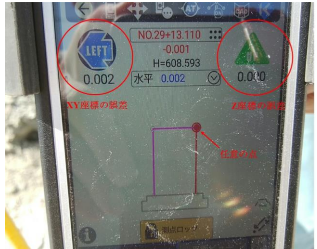
写真-3.7 据付時のタブレット画面
