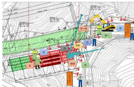
図-3 従来のハザードマップ(橋台工事)
