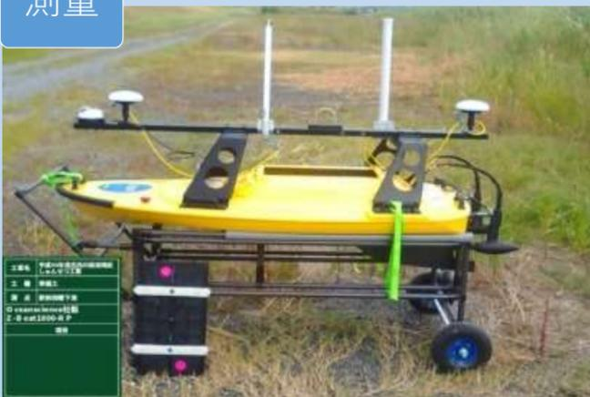
無人の自動航行ラジコンボートのマルチビーム測量で深淺計測
