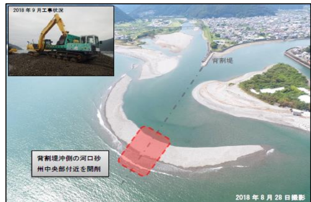
図 6.4 維持浚渫（河口部掘削）の実施箇所イメージ
