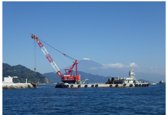
写真-2 航路啓開作業で主要となる起重機船(吊っているブロックは高さ4.5m)
