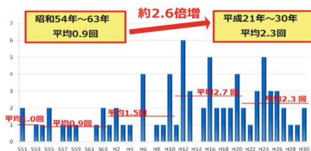
図-1 時間雨量50mm以上の発生回数（浜松観測所）
