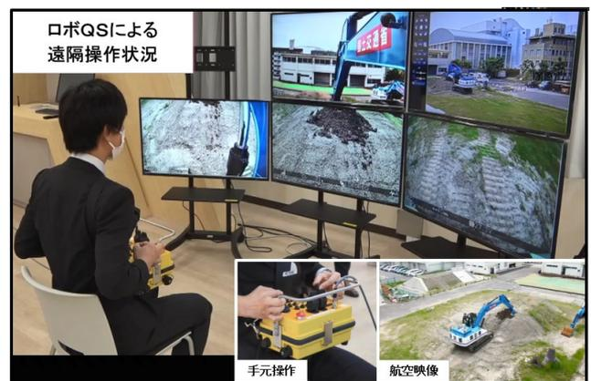
図-3-3 モニタ付遠隔操縦装置
