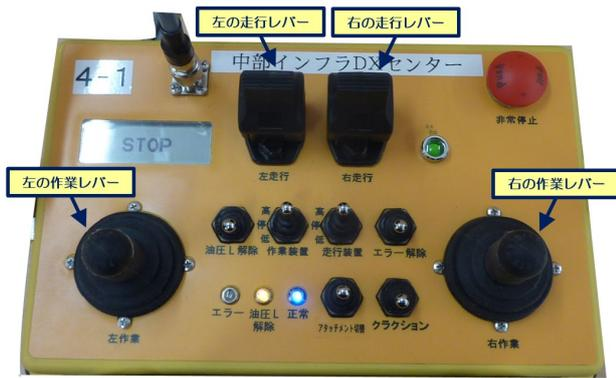
図-3-4 ロボQS操作用コントローラ
