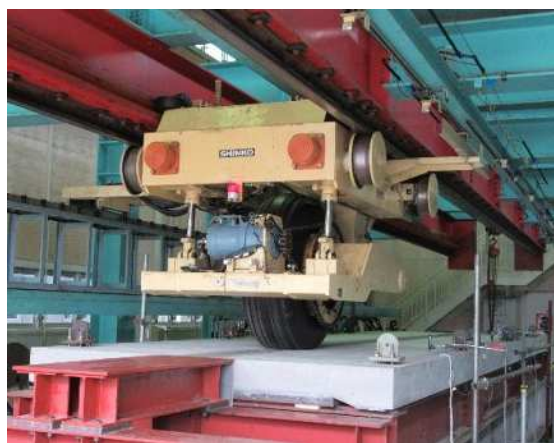
写真-1 輪荷重走行試験実施状況
