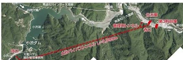
図-2 土砂バイパストンネル位置図
