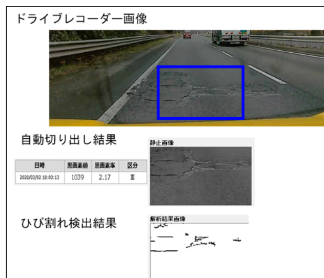
図-12 ひび割れ解析の仕組み
