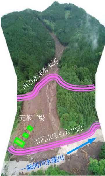
写真-2 水窪町地頭方の斜面崩壊状況
