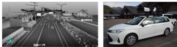
図-14 収集した3次元道路データとデータ収集に使用した計測車両
