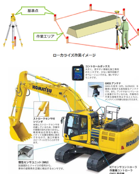
図-6 ローカライズ作業イメージ・MCバックホウ
