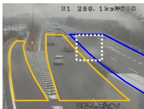
図-11 カメラカバーに付着した水滴による誤検知。
