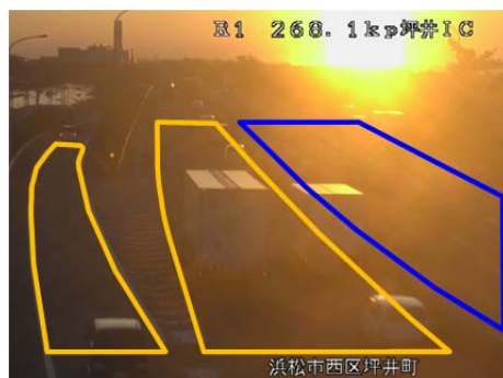
図-10 朝日の逆光による誤検知。
