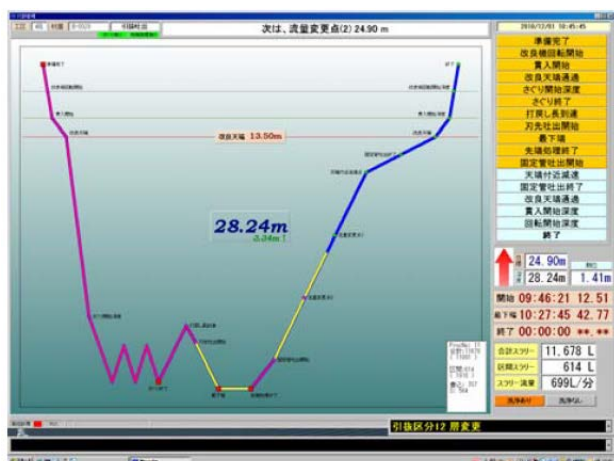
図-5 「ポコム12号」自動打設システム画面
