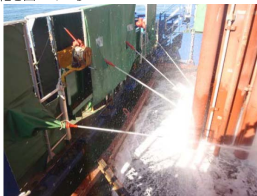
図-7 改良機の遠隔放水銃による洗浄
