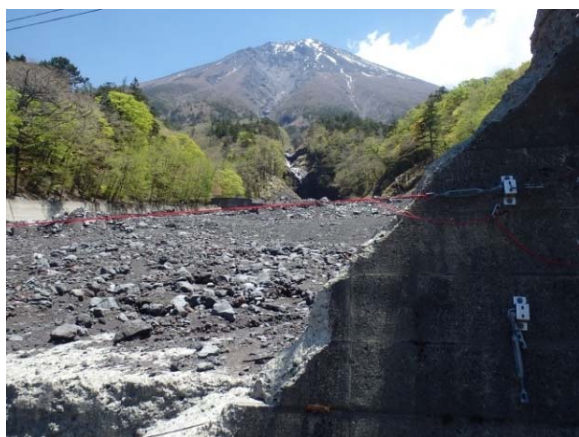
図-9 ワイヤーセンサー設置状況（大滝）
