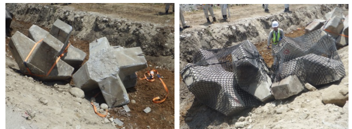
写-3 左：ケース2（ベルト破断） 右：ケース3（袋破断）
