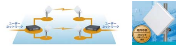
図7 25GHz無線LANの並列接続
