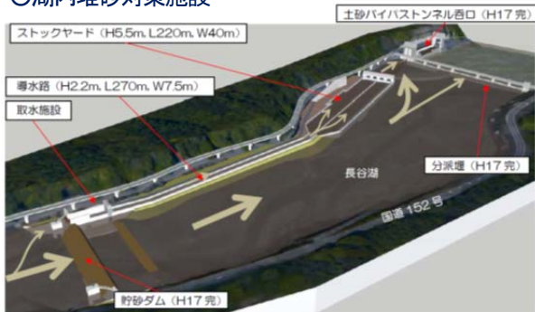
図-2.1 湖内堆砂対策施設レイアウト
