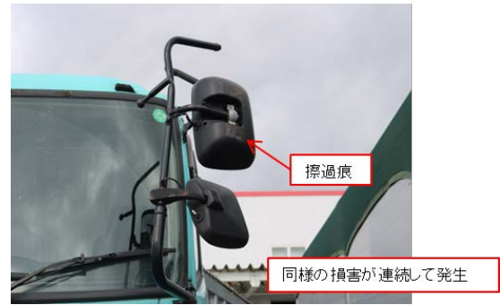
図5 保護鉄板との衝突により発生した車両の損害
