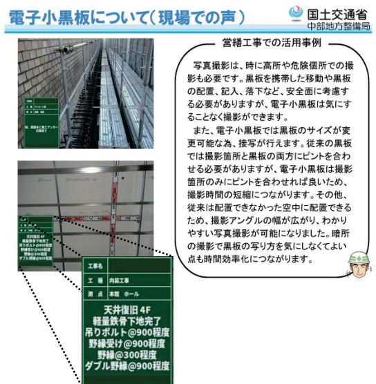
図-7 平成29年度 営繕工事における電子小黒板活用事例
