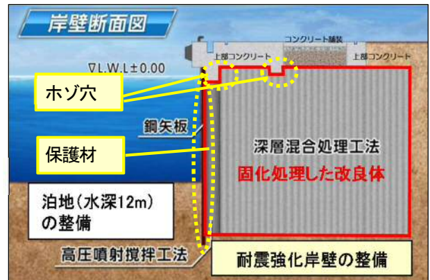
図-4 疑似重力式構造の概念図
