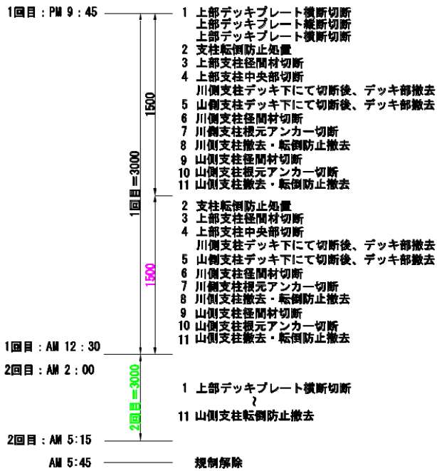
図-9 1日の施工サイクル
