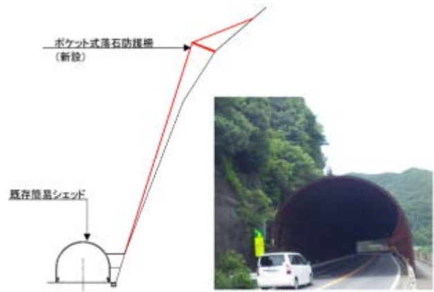
図-6 簡易ロックシェッド補修
