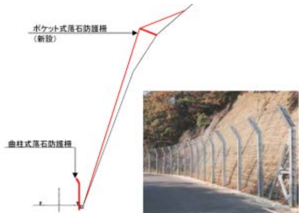
図-8 簡易ロックシェッド撤去、曲柱式落石防護柵設置
