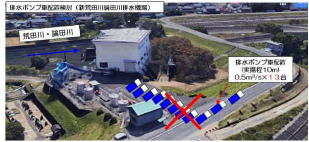
図-4 排水ポンプ車13台配置検討
