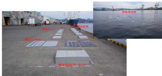
図-5 模擬変状の平面配置と設置状況
