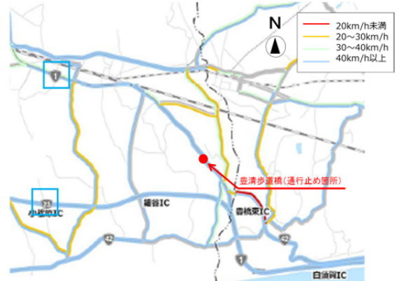
図-6 補修工事近郊における通行止め時の交通状況 (ETC2.0より)
