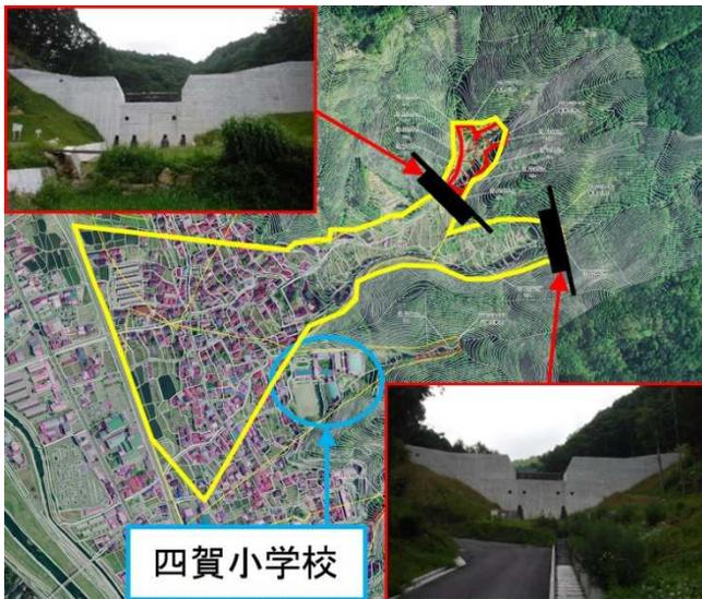
図-3 桑原二沢砂防堰堤と四賀小学校の位置図及び解除された土砂災害特別警戒区域図
