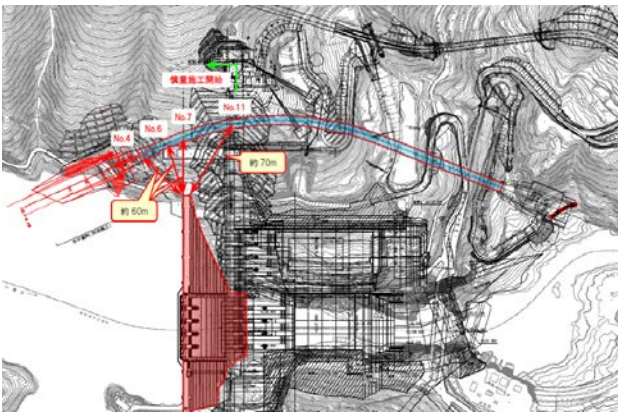
図-6 新丸山ダム転流工平面図
