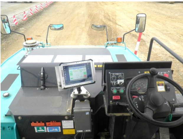
写真-6 GNSS受信機等を搭載したタイヤローラ
