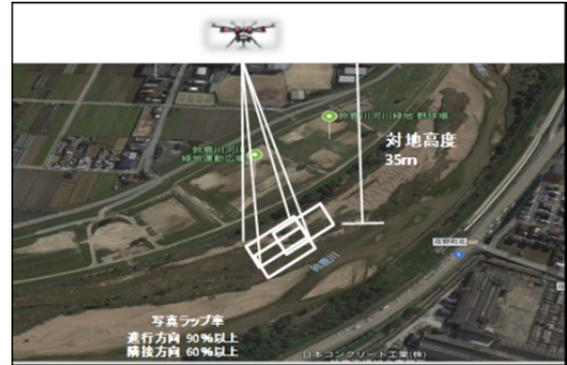
図-2 空中写真測量状況イメージ
