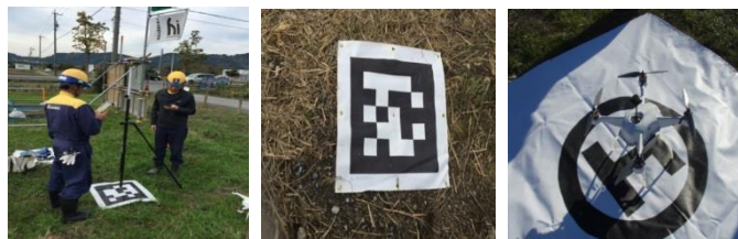
図-4_測量時の写真（左：GCP設置、中：GCP、右：使用したUAV）
