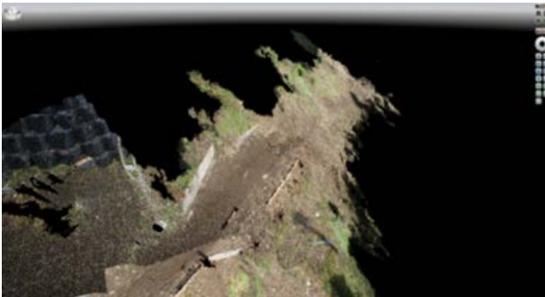
(写真4) UAVにより取得した点群データ
